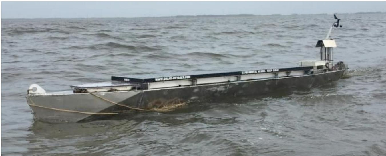
O barco robot “Voyager Solar” foi construído por dois amigos e será a primeira embarcação, movida a energia solar, projetada para atravessar o oceano Atlântico.
