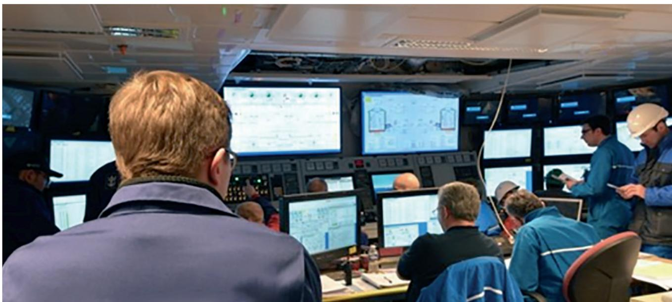
Contam-se ainda quatro motores auxiliares, da mesma série da Wärtsilä, mas com 12 cilindros, de 14 400 kW cada, além dos três azipods ABB e 4 propulsores à proa para facilitar as operações em porto. Existem 860 quilómetros de tubagens, cem mil pontos de luz distribuídos pelos dezoito decks, dezasseis dos quais de passageiros e a consola da Casa das Máquinas conta com 40 mil indicadores de sinalização para aferir o estado conforme de todas as instalações.
